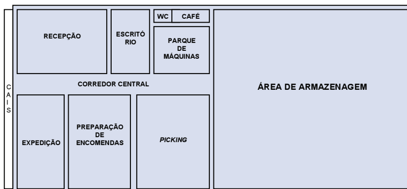
Figura 6 - Planta de um armazém
